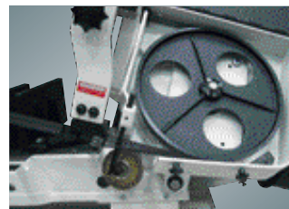
Messinkinen harjapyörä terän puhdistukseen
