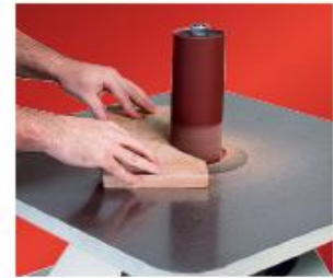
Läpimitaltaan 38 mm-hiomakara hioo naarmuttamatta ja pidentää holkkien käyttöikä
